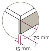
Paneles de sustitución inyectados
