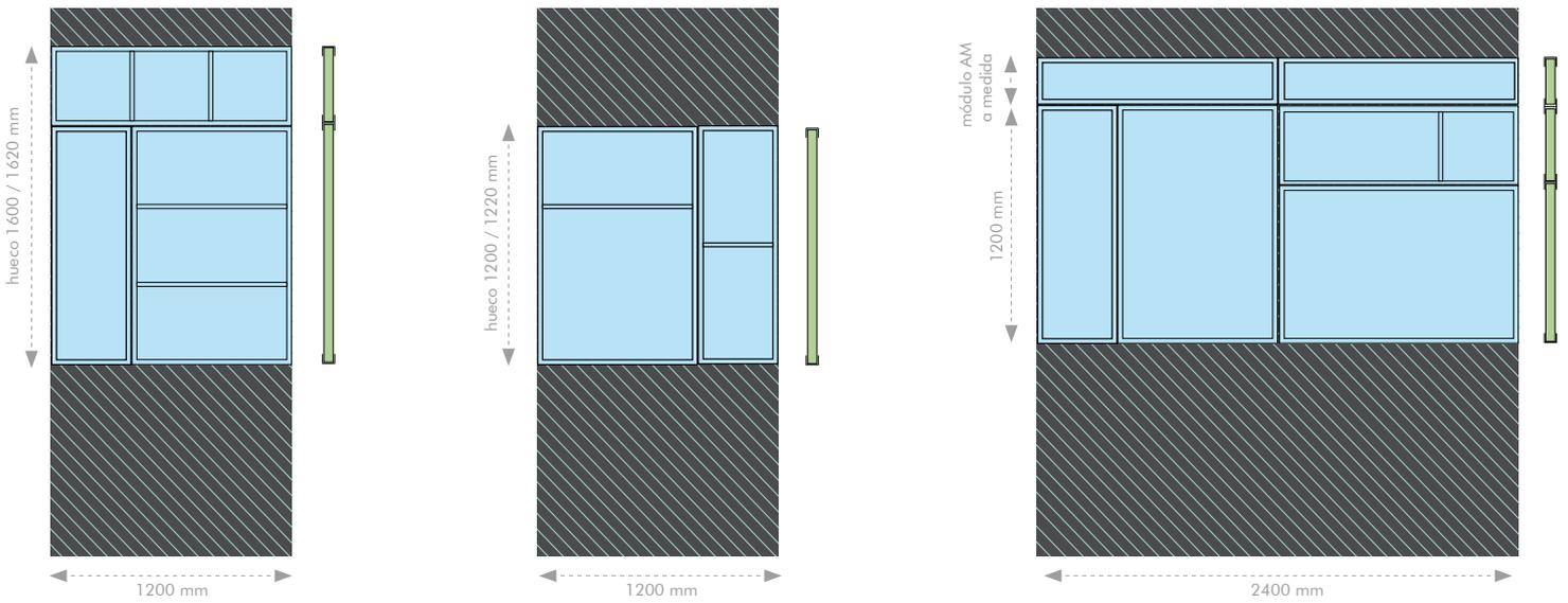
Colocación sobre muretes a techos altos con brazo expansor
