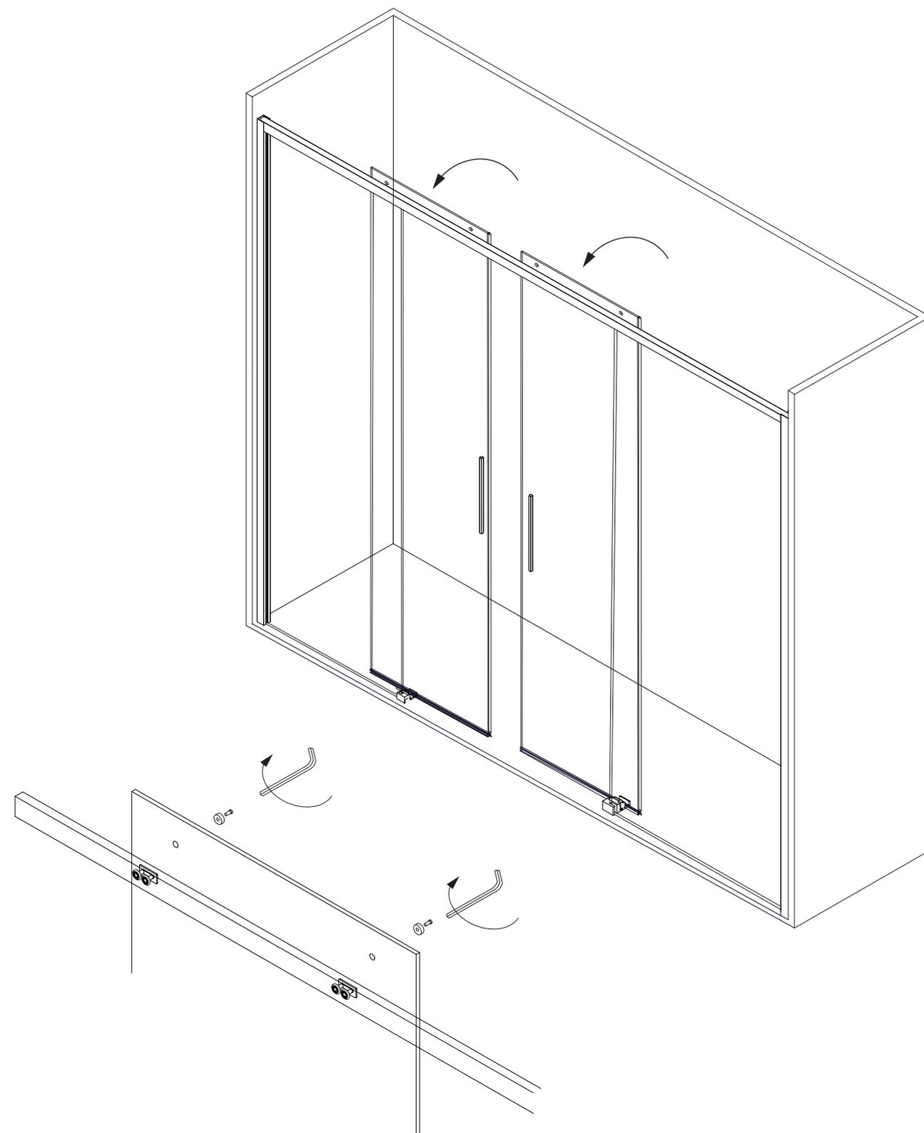
Una vez ajustada la puerta mediante la arandela excéntrica, Presionar el tornillo para fijar la verticalidad de la puerta.
