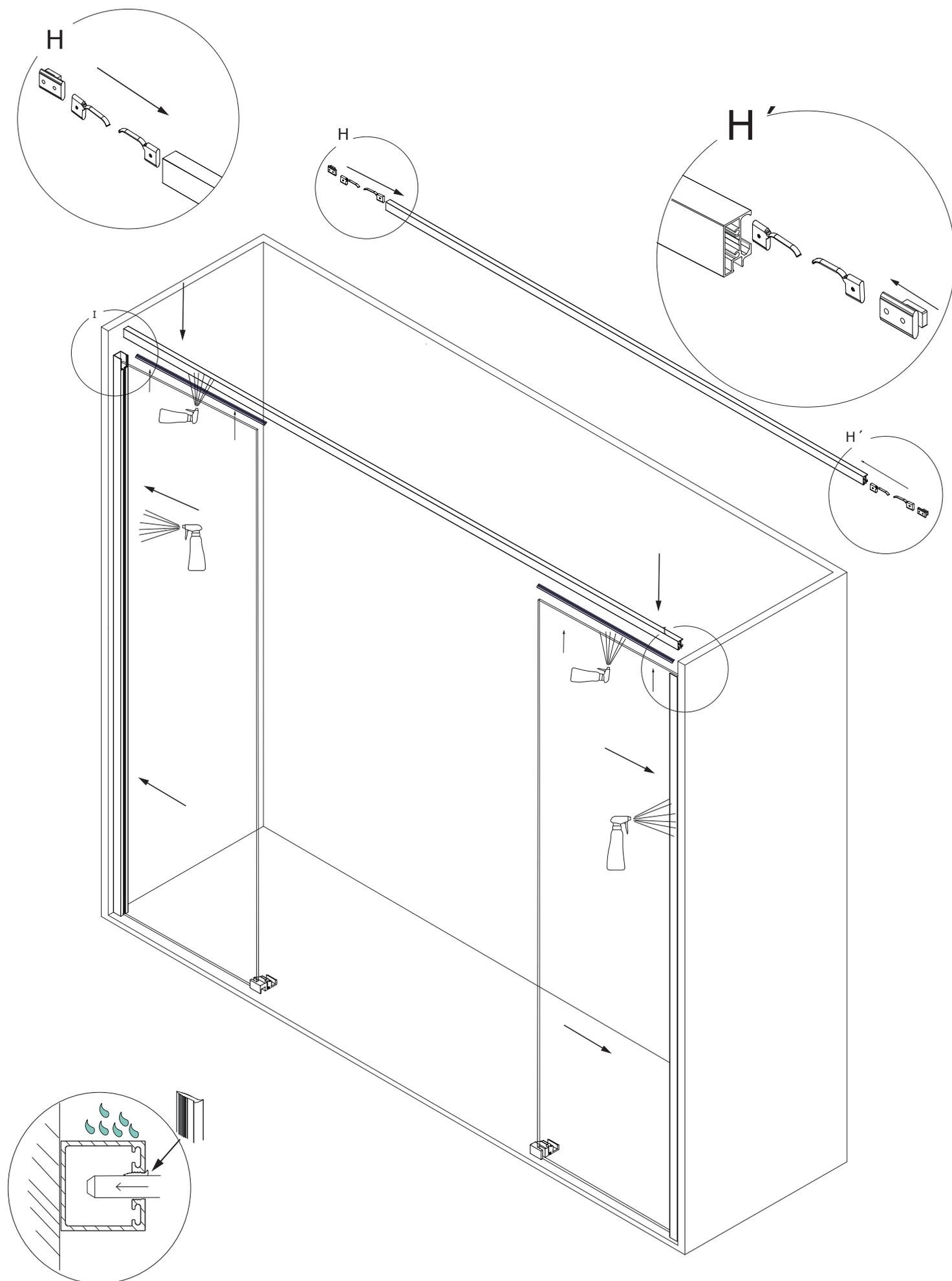
Una vez colocada la guía superior encajada en los perfiles y en el vidrio, rociar agua sobre el fijo y el perfil para acoplar con facilidad la junta de estanqueidad
