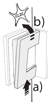
Calzo para montaje de la puerta a la altura correcta
