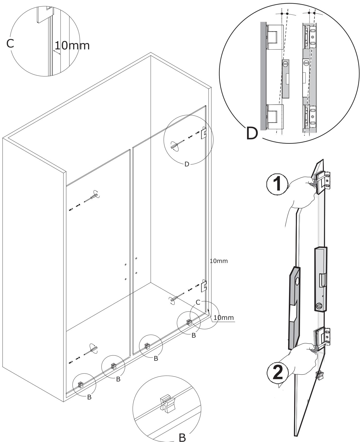
Calzo para montaje de la puerta a la altura correcta
